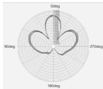
G-8 5.8 GHz アンテナ の方位角平面パターン
